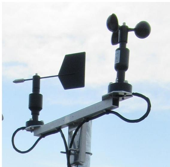
図 13.風向風速計の外観
